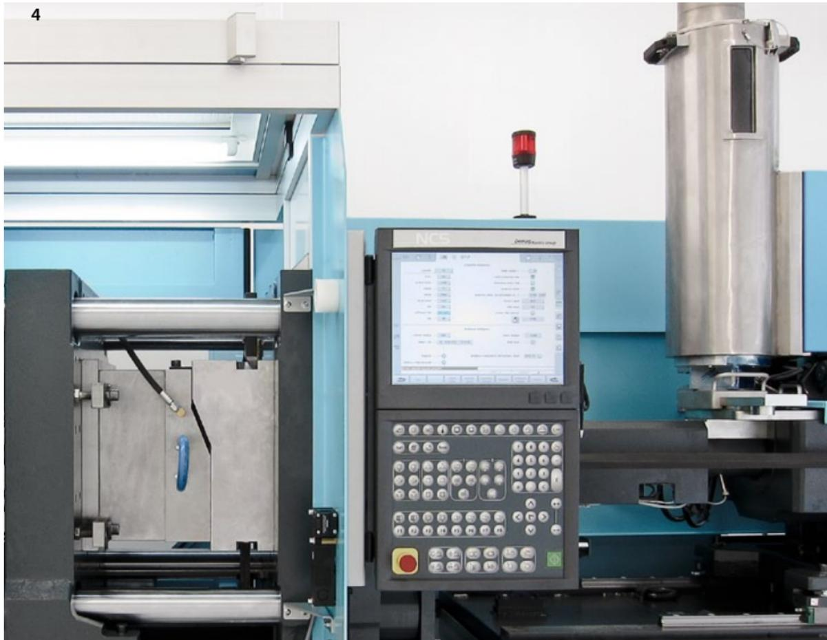
**Vollelektrische Spritzgießmaschine, schmierfettfreies Formwerkzeug und laminarströmende Reinluft für die Fertigung von Spritzgussteilen unter Reinraumbedingung.**
